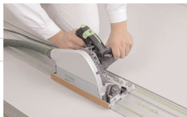
Ręczna pilarka tarczowa z tarczą z węglkami spiekanyymi
